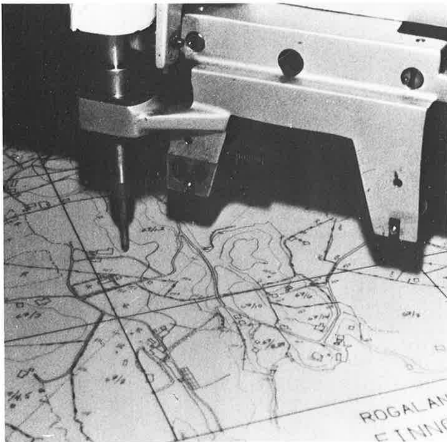
Når man ønsker et rentegnet kart, tas dataene ut fra datamaskinen over linje direkte til tegnemaskinen som automatisk tegner kartet.
