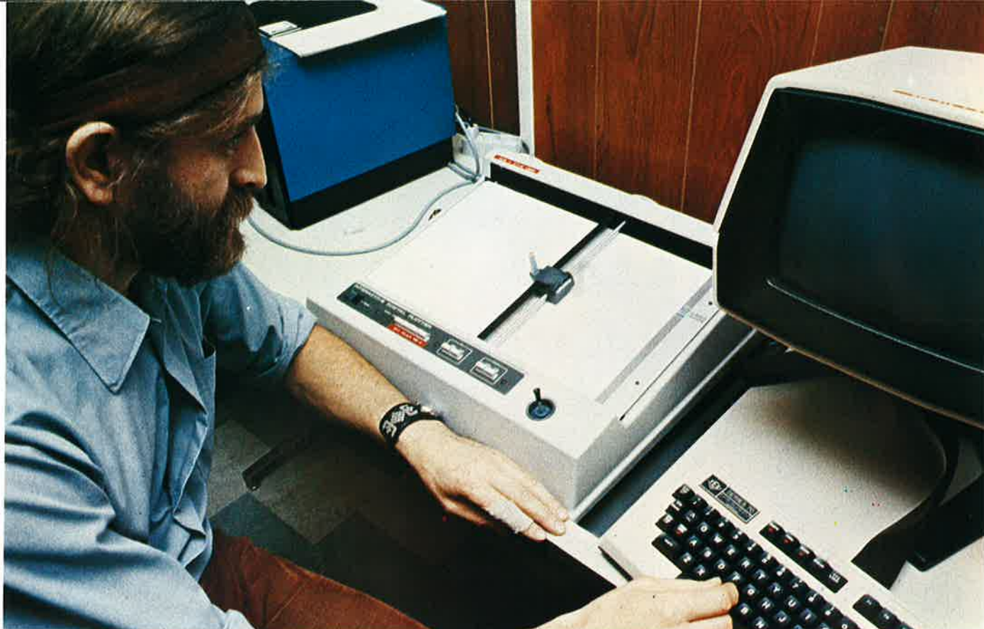
I Jordbunnsklassifiseringssystemet tar man ut informasjonen fra databasen på grafiske plottere, og man kan variere skalaen på kartene etter hvor stort behovet for detaljer er.
