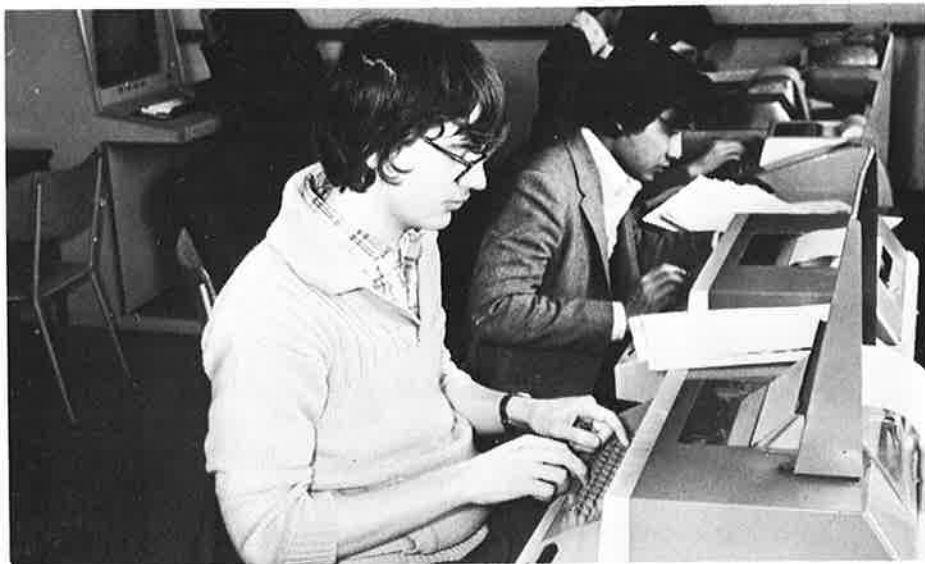
I løpet av de neste 12 månedene vil de teletypemaskinene som i dag brukes i undervisningslaboratoriene bli byttet ut med billedskjermsterminaler.
