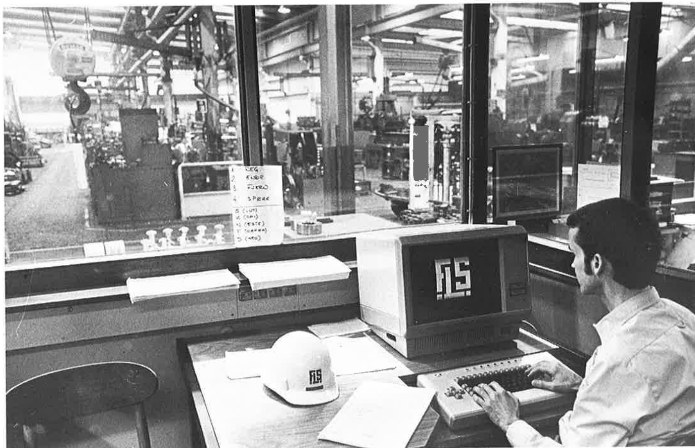
NORD-anlegg benyttes hos F.L. Smidth bl.a. til kort- og langtidsplanlegging, oppfølging av arbeidsordre og material- og produksjonsstyring.
