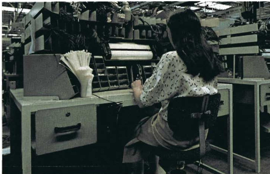
Fire etiketter skrives ut av datamaskinen og festes på hver ledning: en for hver av de to komponentene som sammenkobles, og en for hver ledningsende.
